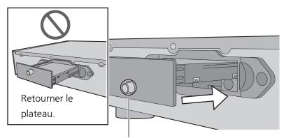
Vérifier la position de la vis de fixation.
