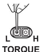
③Når du har trykket på drejningsmomentknappen, blinker bekræftelseslampe det angivne antal gange for at vise den nye indstilling, forbliver tændt i to sekunder og slukker så.
